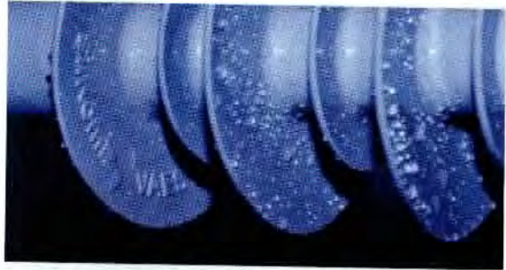
Şekil 11 - Kompozit izolatörün yüzeyde su tutmama (hidrofobik) özelliği (VAEST)
