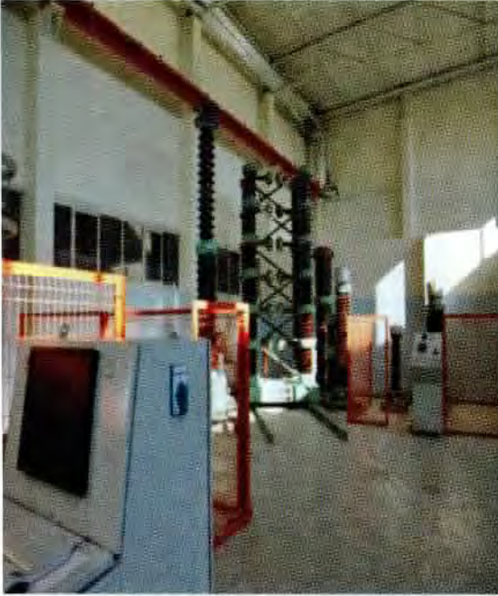
Şekil 13 - 1 MV 25 kJ darbe ve 400 kV AA test kaynağı (VAEST)
