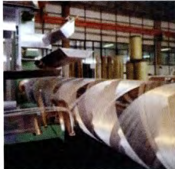
Şekil 2 - Cam elyafı "filaman sargı" görünümü (BARIŞ)
