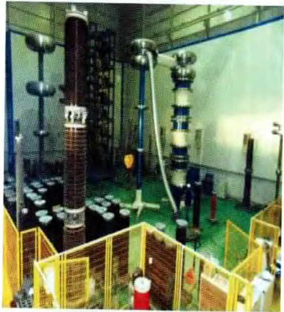
Şekil 12 - 3MV-118 kJ darbe kaynağı ile 750 kV (4A) alternatif akım test kaynağı (EMEK)
