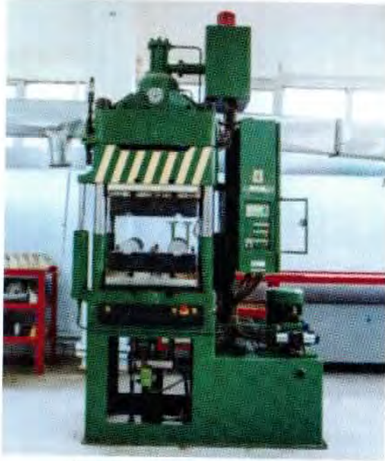
Şekil 10 - 100 ton HTV pres ve kalıp (VAEST)
