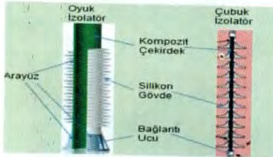
Şekil 5 - Oyuk ve çubuk kompozit izolatör yapısı
